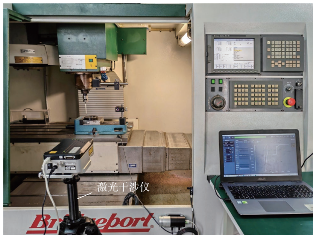
图 6 使用激光干涉仪标定测头测量运动学模型参数 Fig.6 Calibration of kinematic model parameters for probe measurement with a laser interferometer
